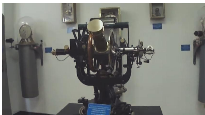
Hier zien we een prachtige AUZ-27 universele theodoliet, een astronomisch instrument om de tijd te bepalen, Duitse makelij, merk Askania Werke, jaar 1935.
